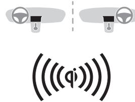
Mit diesem System können tragbare Geräte wie Smartphones kabellos geladen werden, indem das Prinzip der magnetischen Induktion gemäß der Norm Qi 1.1 genutzt wird.
