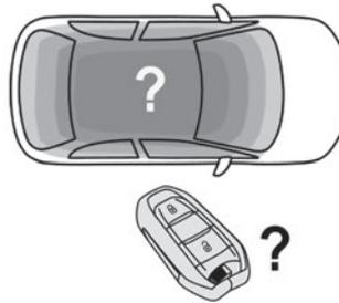
Wenn der elektronische Schlüssel nicht erkannt wird oder sich nicht mehr im Erkennungsbereich befindet, erscheint beim Schließen einer Tür oder bei dem Versuch, den Motor abzustellen, eine Meldung auf dem Kombiinstrument.
