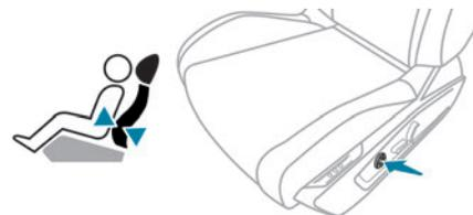
Mit dem Hebel können unabhängig voneinander Tiefe und Höhe der Lendenwirbelstütze im Bereich der Lendenwirbelsäule eingestellt werden.
