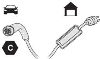
Identifizierungsaufkleber **C** am Ladeanschluss (Fahrzeugseite)
